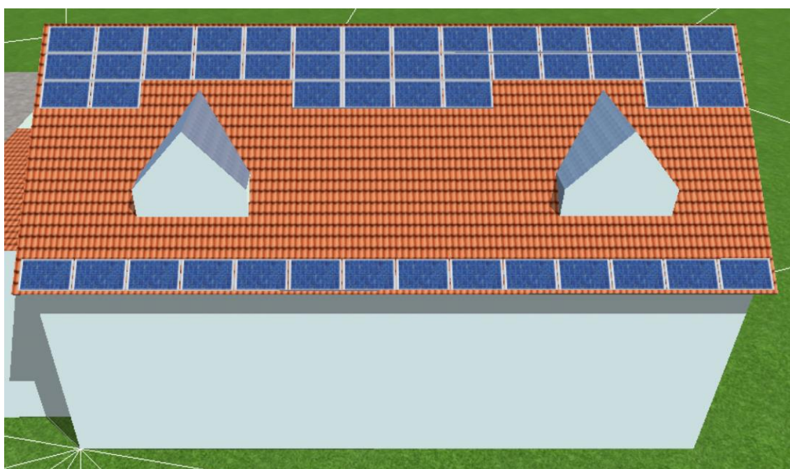
Abbildung 2: Variante Zubau 10 kWp auf dem Altbaudach
